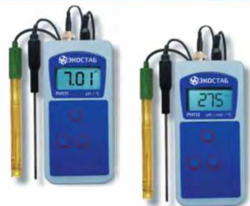
Серия портативных приборов для измерения рН/температуры с температурной компенсацией и возможностью подключения ОВП-электрода (PH112). Функция «HOLD» удерживает результат на дисплее для возможности записи в журнал, а индикация низкого заряда батареи и автоматическое отключение через 8 минут бездействия экономит энергию и продлевает срок службы батареи.
