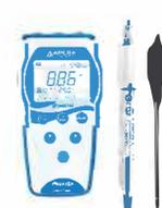
Измерение pH сильных щелочей. Портативный pH-метр ЭКОСТАБ PH231/PH241SA оснащен pH-электродом LabSen® 841 и датчиком температуры MP500, которые предназначены для измерения сильнощелочных растворов.
