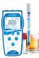
Измерение pH в напитках. Портативный pH-метр ЭКОСТАБ PH231/PH241BR оснащен стеклянным электродом LabSen® 213, предназначенным для профессионального измерения pH при приготовлении напитков, таких как пиво, вино, чайный гриб, кофе, сок и т. д., хорошо работает при высокой температуре (до 100°C).
