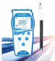
Измерение pH сточных вод. Портативный pH-метр ЭКОСТАБ PH231/PH241WW оснащен электродом pH/температуры LabSen 333 с открытой диафрагмой и твердым электролитом, что предотвращает его загрязнение. Электрод специально предназначен для профессионального измерения pH сточных вод, эмульсий и других мутных водных растворов, содержащих сульфиды и белки.
